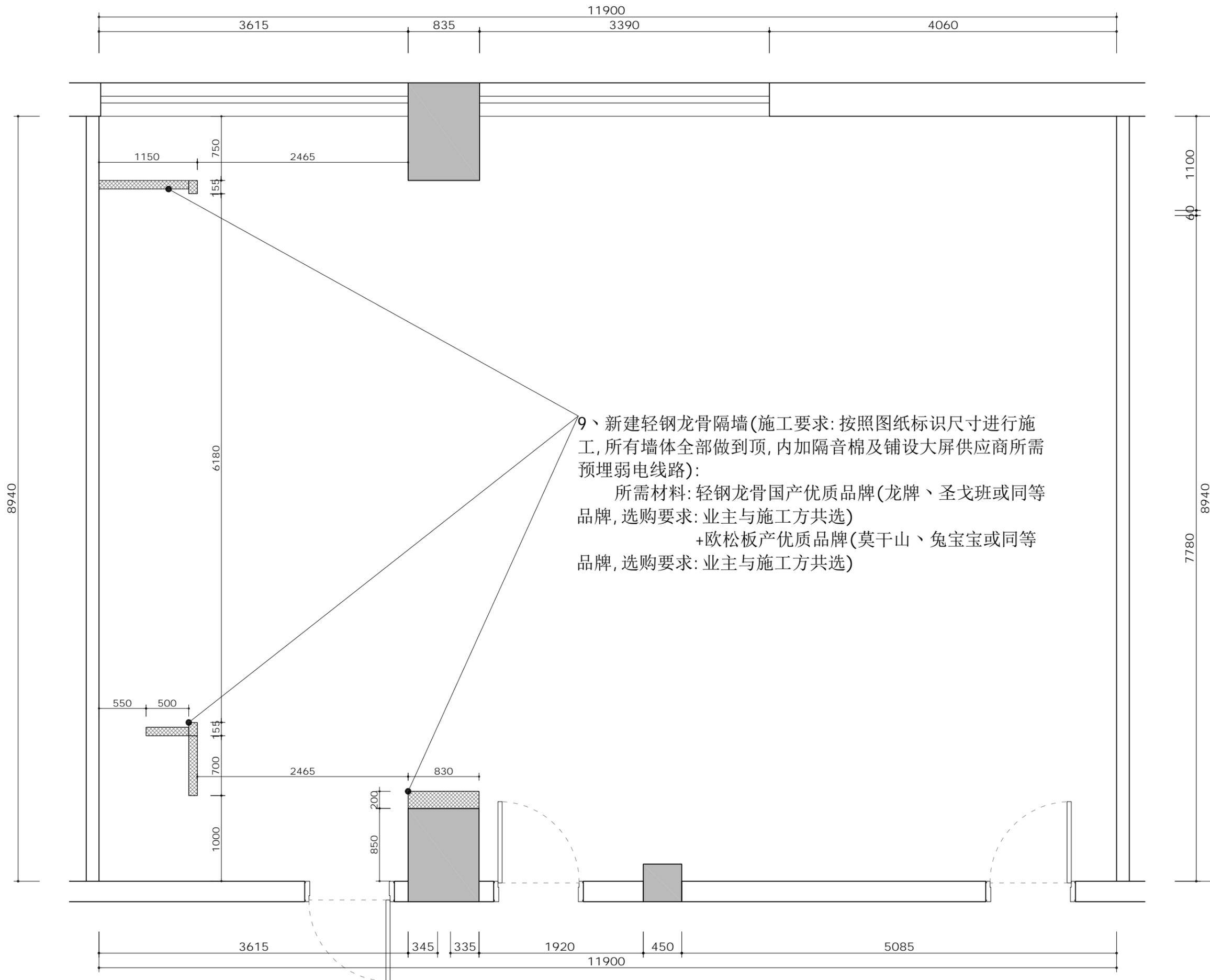
9、新建轻钢龙骨隔墙(施工要求:按照图纸标识尺寸进行施工,所有墙体全部做到顶,内加隔音棉及铺设大屏供应商所需预埋弱电线路):
